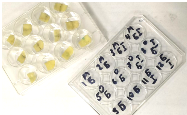
Рисунок 4.12 — Образцы биоткани с лазерными швами в культуральном 12-ти луночном планшете
